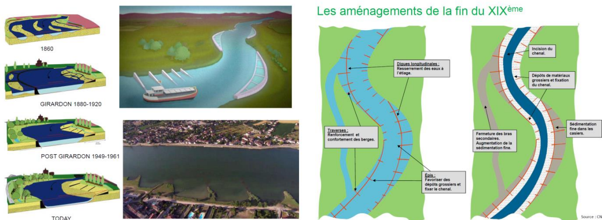
Figura 3-1: esempi di sistemazione del fiume Rodano secondo lo schema di Girardon (Fonte CNR)
