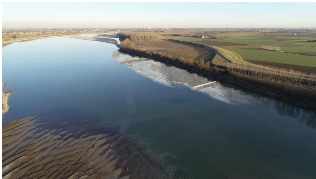
Figura 5-14: simulazione degli effetti indotti dalla realizzazione dei pennelli fluviali
