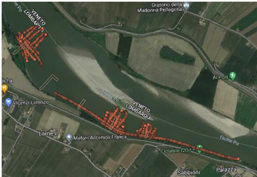
Figura 6-1: Vista dello shapefile dei punti rilevati dall'imbarcazione Luccio in data 22/05/2023 tra le ore 9:00 e le ore 10:30
