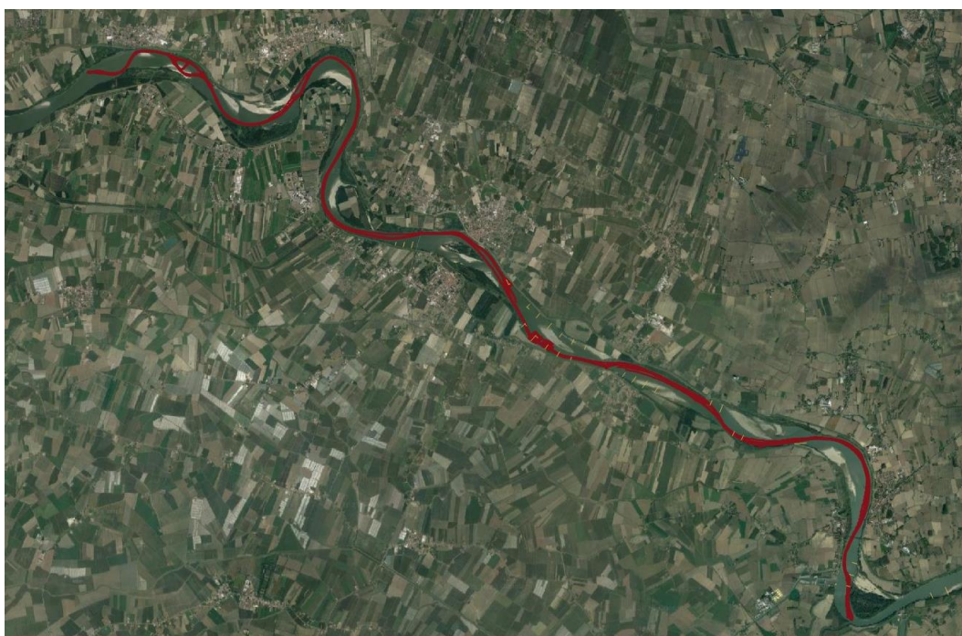
Figura 6-3: Shape file della strisciata batimetrica lungo il fondo alveo
